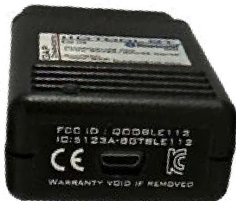
Abbildung 3. Micro- oder Mini-USB-Buchse für USB-Kabel zum Anschluss des IIDTool an einen Computer
