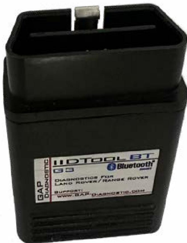
Abbildung 4. OBDII-Anschluss, der den Anschluss des IIDTool an ein Fahrzeug ermöglicht
