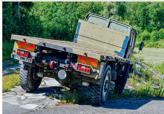
Werden die Fahrzeuge größer, nimmt auch die Verwindung des Rahmens über die gesamte Länge zu.
