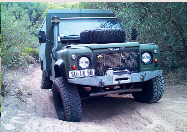
Damit es die Kabine bei unebenen Strecken nicht zerreißt, wird sie auf einen Zwischenrahmen gesetzt.
