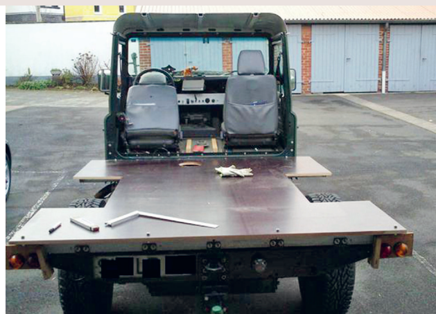
Die Bodenplatte der Kabine sollte aus robustem Material bestehen und mit einer Isolierschicht versehen werden.
