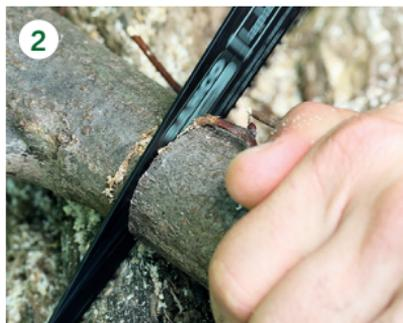
Eine kleine Säge ist leichter und sicherer in der Handhabung als ein großes Haumesser zum Hacken und Spalten.
