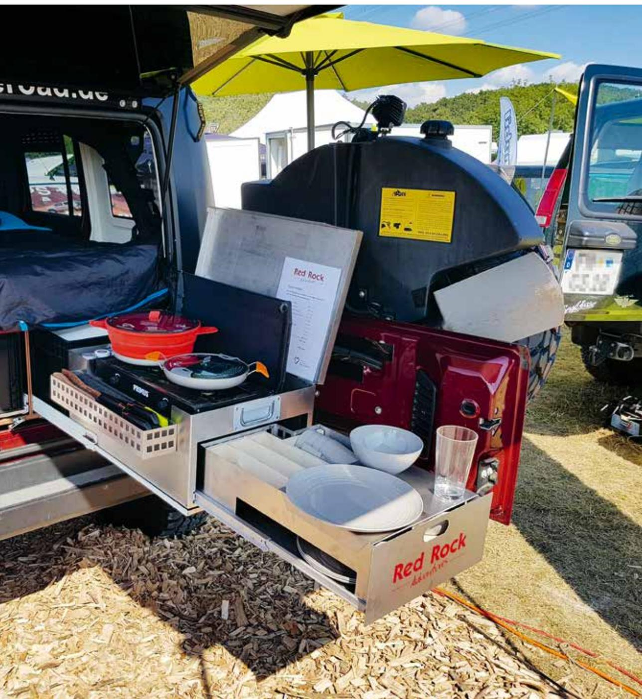
Red Rock Adventures hat einen Einbau für den langen und den kurzen Jeep Wrangler entwickelt. Die Auszüge können Euro-Boxen, die kompakte Red-Rock-Küchenbox »Mokubo« und eine Kühlbox aufnehmen.
